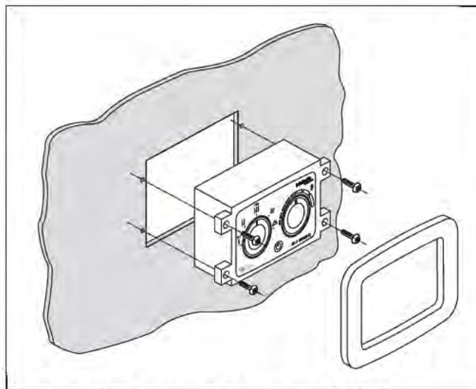
Fig. 30: Montage de l'organe de commande MC04/05
