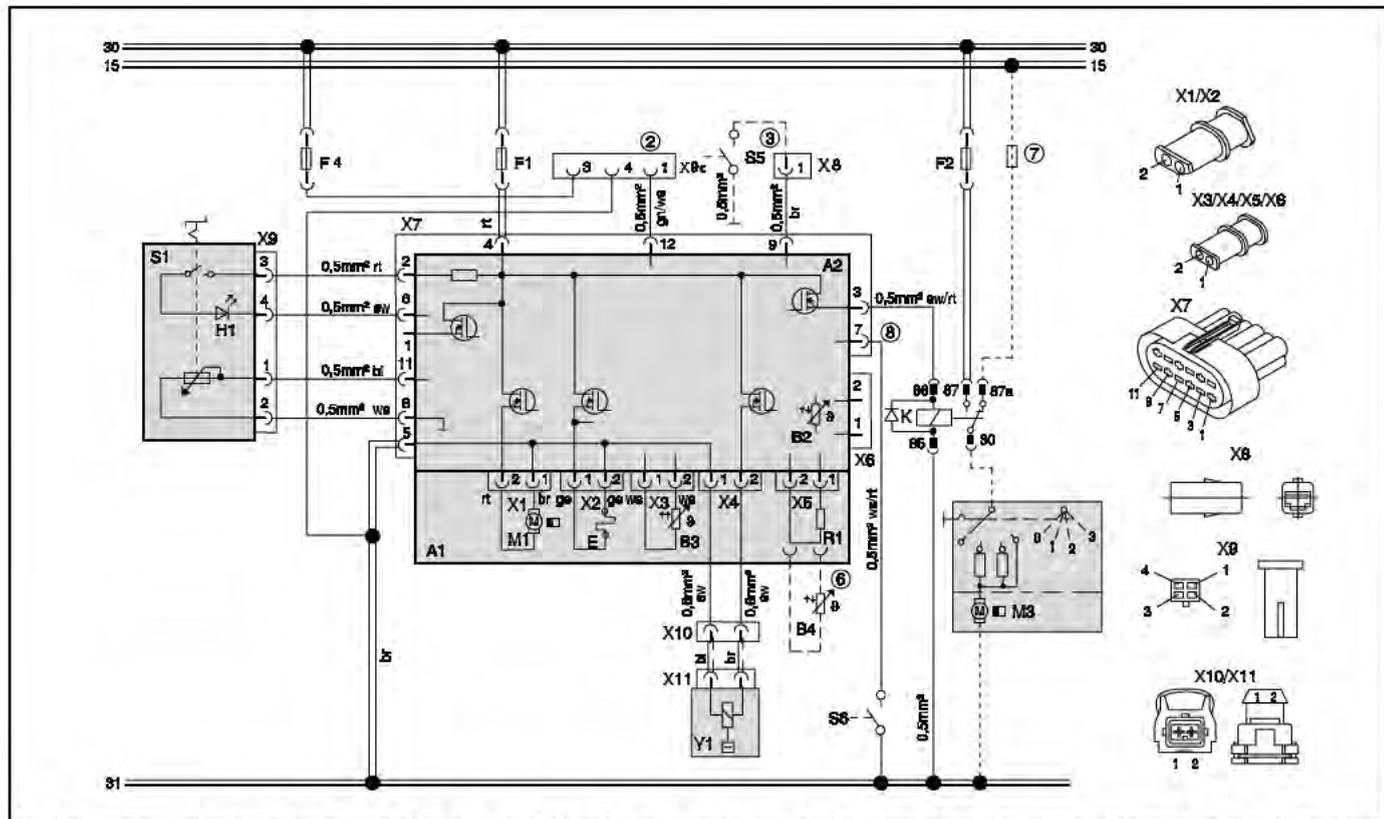
Fig. 33: Schéma électrique d'ensemble Air Top Evo 3900 et Air Top Evo 5500, 12 V/24 V avec organe de commande et soufflante du véhicule; légende : voir pages 33 et 34
