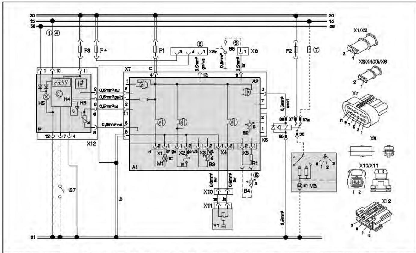
Fig. 35: Schéma électrique d'ensemble Air Top Evo 3900 et Air Top Evo 5500, 12 V/24 V avec horloge polyvalente et soufflante du véhicule, légende : voir pages 33 et 34
