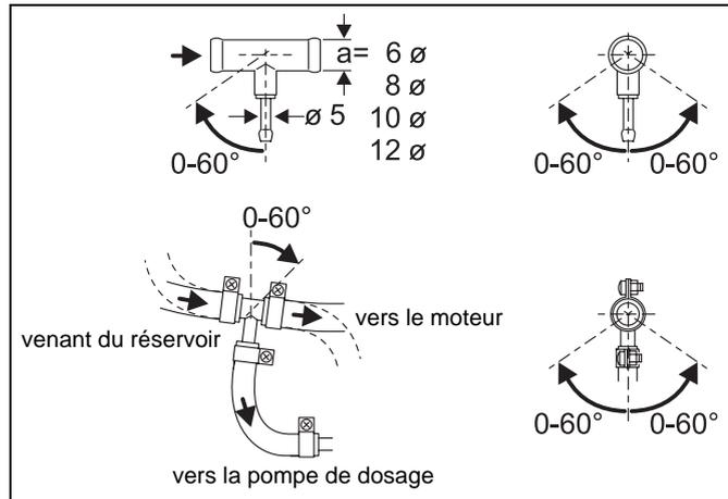
**Fig. 10: point de prélèvement de carburant Webasto**
