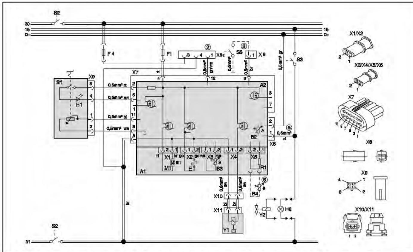
Fig. 34: Schéma électrique d'ensemble Air Top Evo 3900 et Air Top Evo 5500, 24 V fonctionnement selon ADR avec organe de commande ; légende : voir pages 33 et 34
