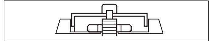
Fig. 29: Montage de l'organe de commande (incorrect)
