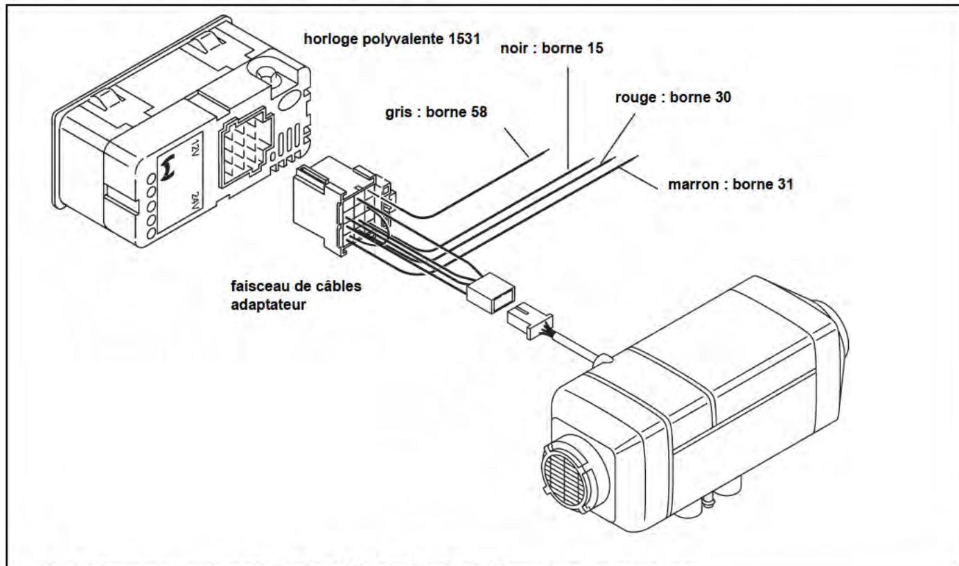
Fig. 31: Schéma des connexions Air Top Evo 3900 et Air Top Evo 5500 avec horloge polyvalente
