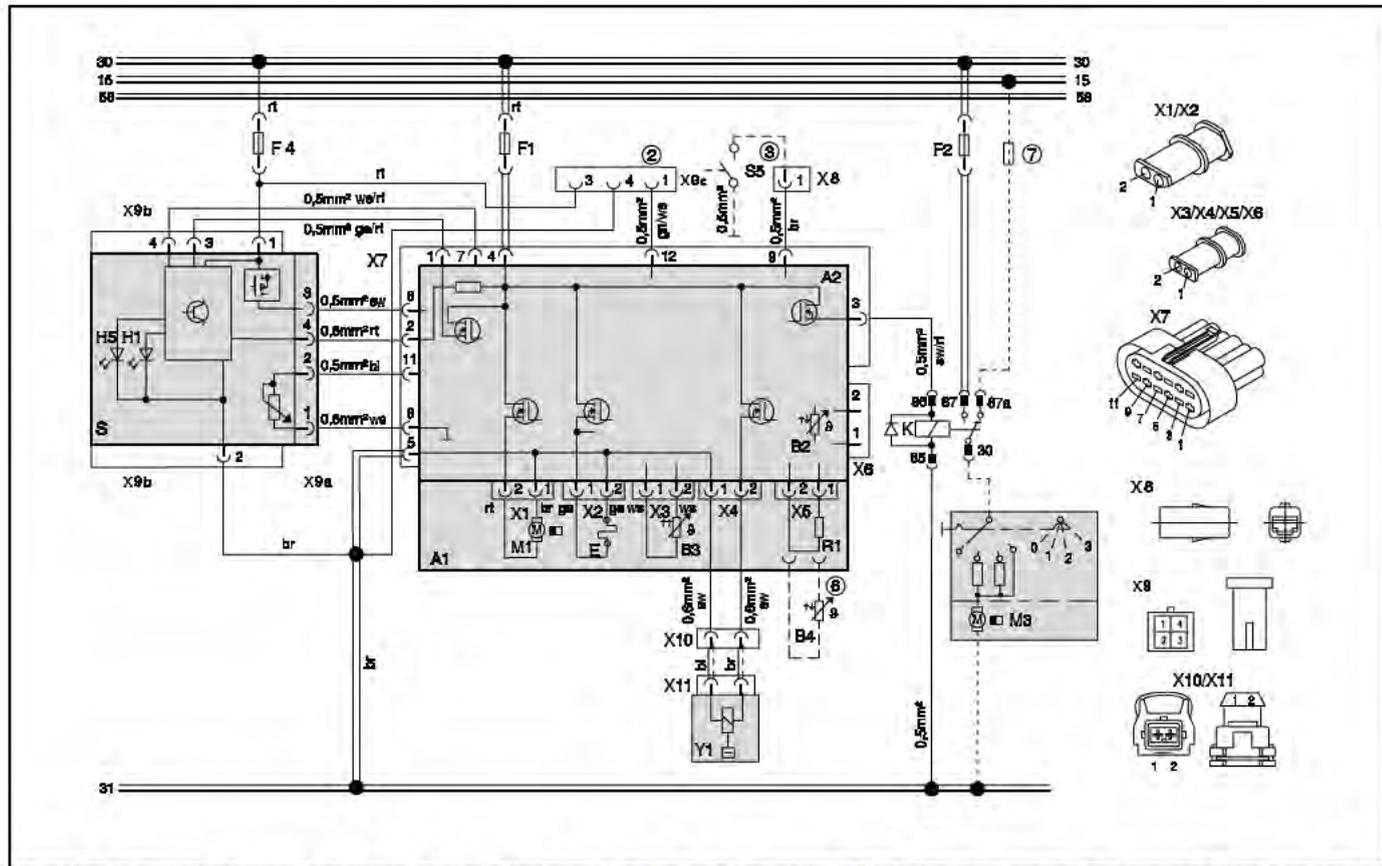
Fig. 37: Schéma électrique d'ensemble Air Top Evo 3900 D et Air Top Evo 5500 D, 12 V/24 V avec organe de commande MC04/05 et soufflante du véhicule ; légende : voir pages 33 et 34
