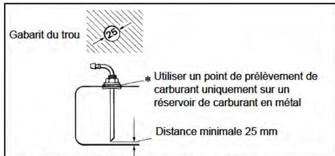
Fig. 11: point de prélèvement de carburant Webasto
