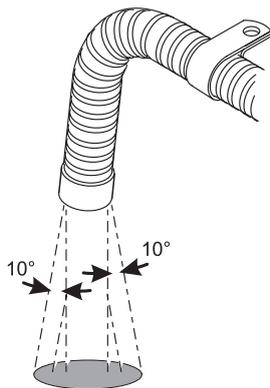
Sens de sortie pratiquement vertical  $90^\circ \pm 10^\circ$
