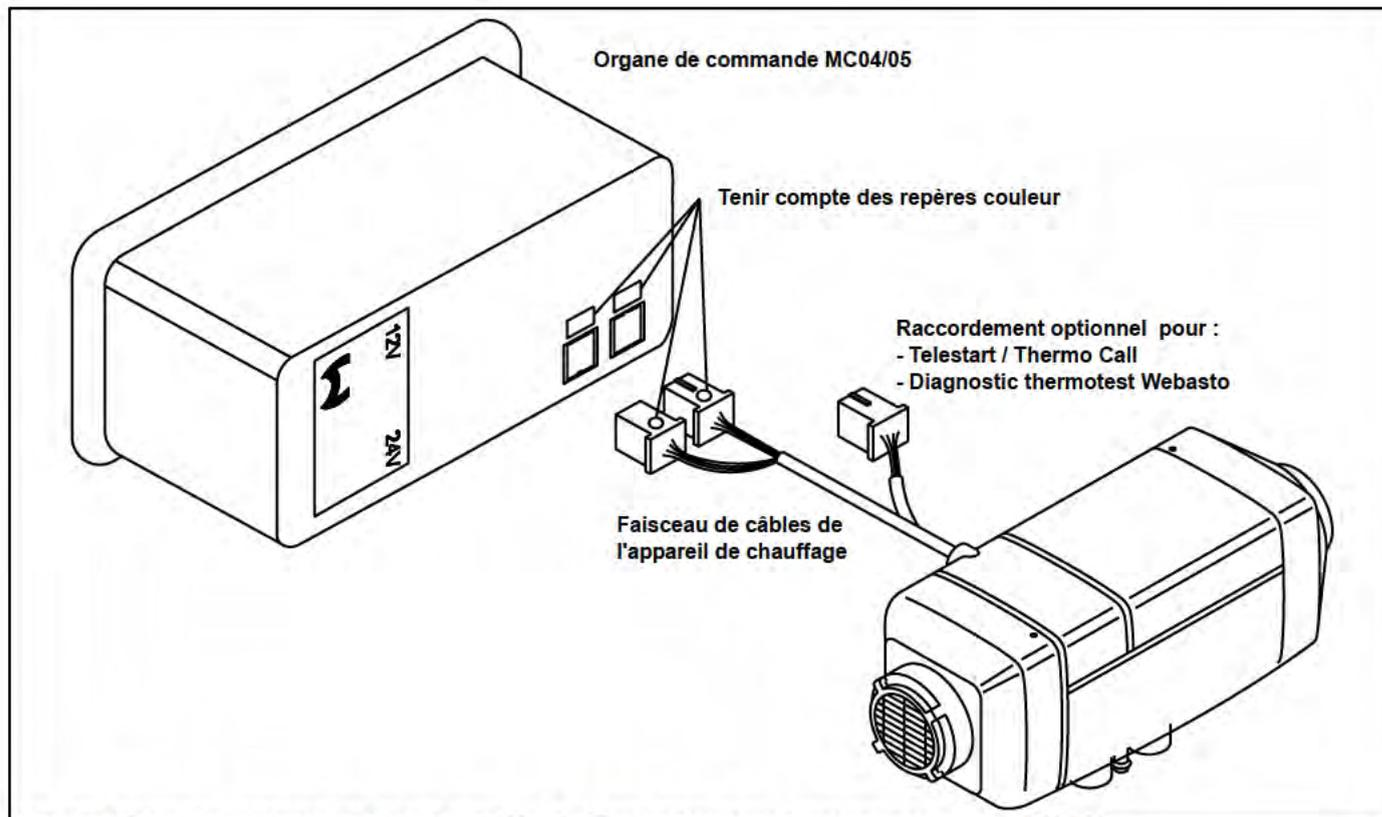
Fig. 32: Schéma des connexions Air Top Evo 3900 et Air Top Evo 5500 avec organe de commande MC04/05
