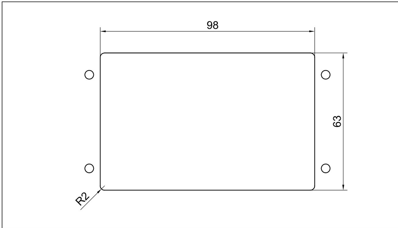
Fig. 40: Gabarit de perçage organe de commande MC04/05
