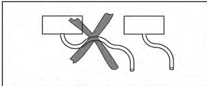
Fig. 20: Eviter la formation de condensation d'eau
